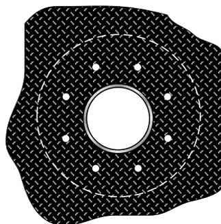
Izolaci proděrujte v oblasti závitů a vyřízněte kolem průchodu. Poté izolaci aplikujte na pevnou přírubu.
